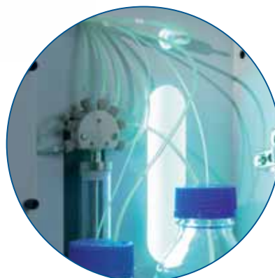
Wysokoefektywna mineralizacja UV przy długości fali 187 i 254 nm
