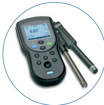
Ilustracja 10: Czujnik LDO jest dostępny także w wersji przenośnej do zastosowania w warunkach polowych i laboratoryjnych.
