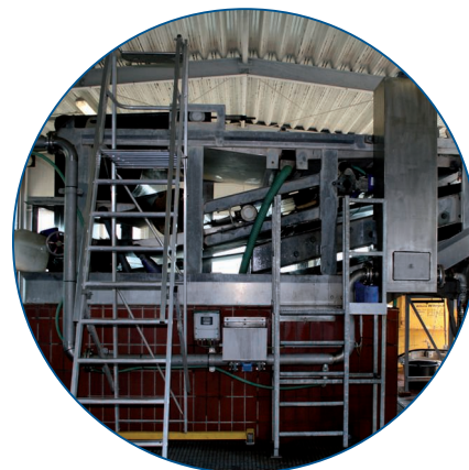
Ilustracja 8: Prasa z filtrem taśmowym do obróbki osadu
