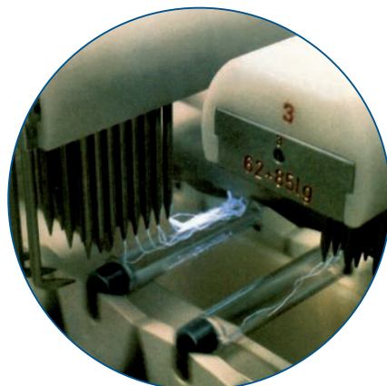
Rys 2: 100% kontrola: Przed napełnieniem każda kuweta jest kontrolowana pod kątem ewentualnych uszkodzeń próbek.
