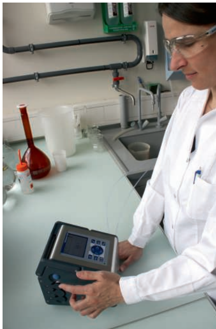
Urządzenie ORBISPHERE 3100 w zastosowaniu laboratoryjnym. Analizator może pracować zarówno w środowiskach laboratoryjnych, jak i procesowych.
